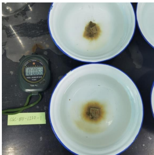
8.5.1-4 1号试样土块试验 10min 状态
